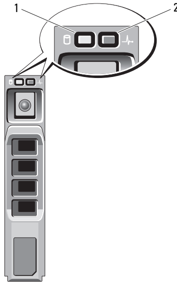
Ilustración 1-3. Indicadores LED del portaunidades de disco físico
